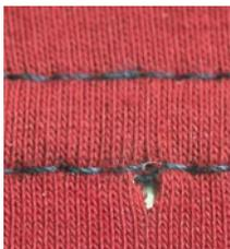
Las mallas se dañan – la prueba se prosigue con el siguiente grueso inferior de aguja.
