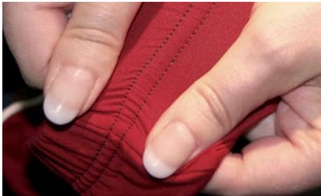
Comprobación de la costura: mediante ligeros movimientos de tracción y cizallamiento se pueden ver los daños en el material (foto abajo a la izquierda).
