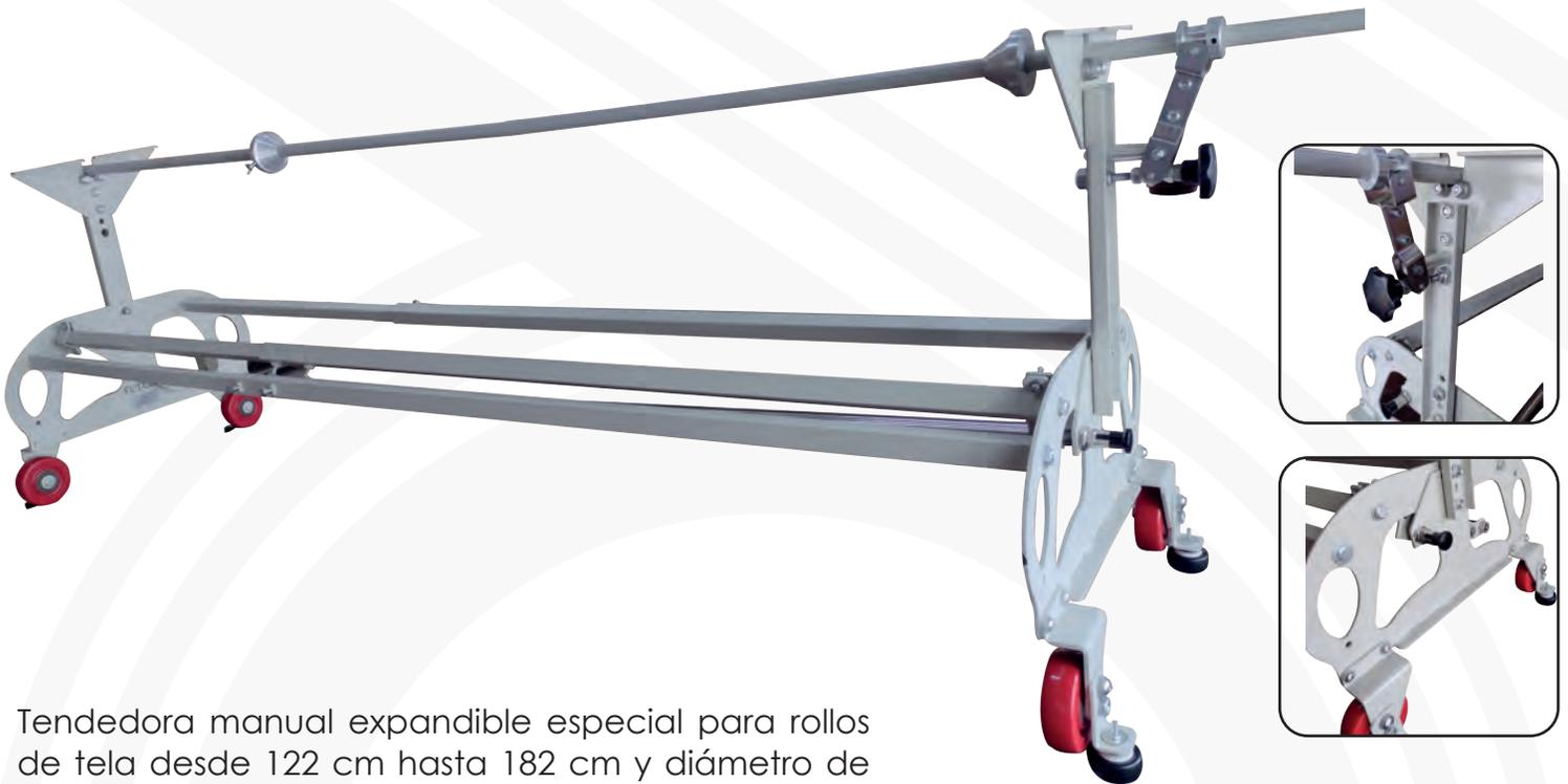
Tendedora manual expandible especial para rollos de tela desde 122 cm hasta 182 cm y diámetro de hasta 24" (60cm). Altura máxima de tendido 22 cm.
